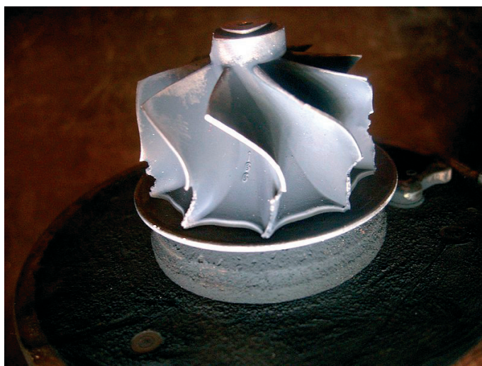
Poškození turbodmychadla od vířivých klapek.
